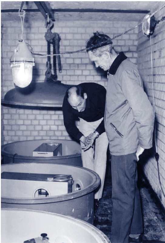
Obr. 2 A. Plešinger (vlevo) u snímačů umístěných ve štolě Kristýna. Pro dosažení maximální možné ochrany jsou snímače umístěny ve speciálních hermetických nádobách, jejichž „pokličky“ je nutno zvedat pomocí ručního jeřábu (viz nejvzdálenější nádoba); na snímku jsou nádoby otevřeny pravděpodobně za účelem údržby. Snímače jsou na stejném místě po celou dobu existence stanice. Nedatované historické foto – archiv seismického odd.
