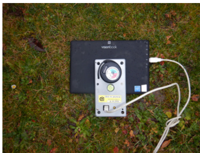
Obr. 10 Sestava ČMI akreditované aparatury SeisMini 1 s registračním tabletem Umax-visionbook
