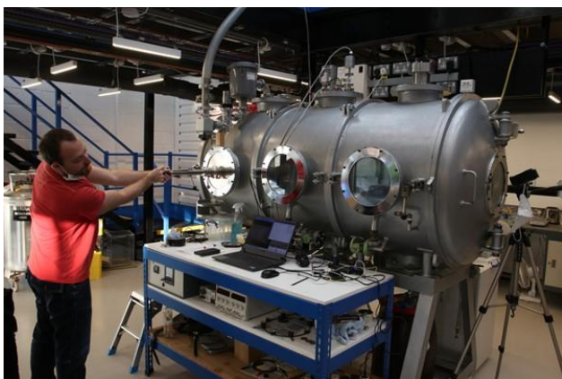
Pohled na nízkotlakovou komoru v britské Open University, ve které se pokusy s bahnem dělaly. Na snímku je jeden ze spoluautorů – Ondřej Krýza z Geofyzikálního ústavu AV ČR. Komora umožňuje snížit atmosférický tlak na průměrné hodnoty panující na povrchu Marsu během pár minut. FOTO: Petr Brož
